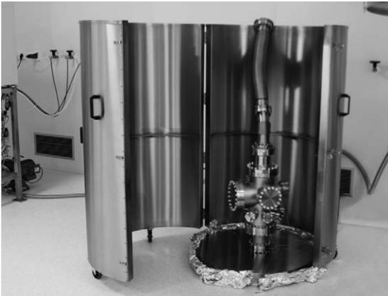
Darüber hinaus haben wir die Möglichkeit, komplette Vakuumkammern mit einem Durchmesser bis 900 mm und einer Höhe bis zu 1400 mm bis 250 °C unter Vakuum auszuheizen und gleichzeitig das Ausgasverhalten mittels Massenspektroskopie zu bestimmen.
