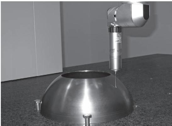
Wir haben unter Verknüpfung mehrerer moderner Mess- und Bearbeitungsverfahren einen Prozess entwickelt, bei dem die fertigungsbedingten Abweichungen von Halbzeugen wie Rohren, Kugeln, Klöpperböden usw. erfasst und bei der Konstruktion und Fertigung kompensiert werden.
