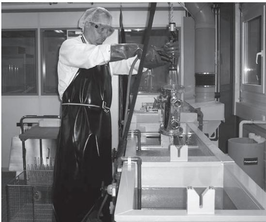
Das Elektropolieren ist bei uns ein Standardverfahren zur Oberflächenveredelung der Bauteile, das im Reinraum durchgeführt wird.
