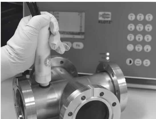
Für die Klassifizierung der Bauteile nach der Reinigung in eine Partikelfreiheitsklasse nach ISO 14644 kann eine Partikelmessung durchgeführt werden.
