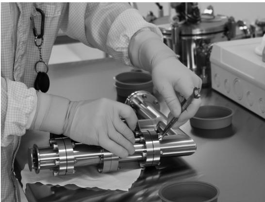
Wir bieten die Möglichkeit, Baugruppen mit hohen Ansprüchen an Partikelfreiheit unter Reinraumbedingungen zu montieren. Hierzu stehen uns Reinräume bis zur Reinheitsklasse ISO 5 zur Verfügung, in denen auch große Baugruppen montiert werden können.
