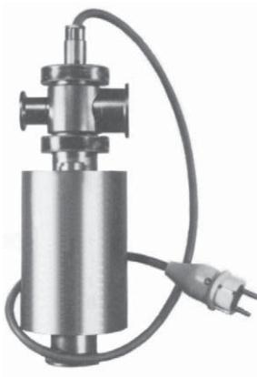
KF-Adsorptionsfallen kommen üblicherweise zwischen mechanischen Vorpumpen und dem Rezipienten zum Einsatz. Sie verhindern eine Rückströmung von Dämpfen und Pumpenölen in die Kammer. Die Fallen werden in der Regel mit Zeolith befüllt, welches Partikel an seiner großen Oberfläche bindet.
