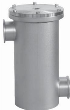
LN<sub>2</sub> Kühlfallen werden aus Edelstahl gefertigt. Sie kommen vorwiegend in Hochvakuum- und Ultrahochvakuum- Anlagen zum Einsatz. An den Wänden der Falle kondensieren Wasser, Lösungsmittel, Treibmittel und Gase, deren Siedetemperaturen über 77 K liegen (z. B. CO<sub>2</sub>). Sie lassen sich daher auch als Kryopumpen einsetzen.
