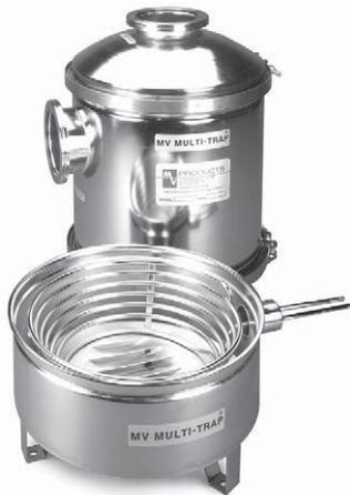
Die mehrstufige Hochleistungsvakuumfalle MULTI-TRAP schützt ölgedichtete und trocken laufende Pumpen, die in reaktiven Prozessen (z. B. TEOS, NITRIDE, HTO, PLASMA) eingesetzt werden. Sie filtert korrosive Dämpfe und durch Arbeitsprozesse entstehende Partikel, die die Vakuumpumpe verschmutzen können, und verlängert damit die Wartungsintervalle bzw. verkürzt Ausfallzeiten. Die dreistufige Anordnung bietet eine fast vollständige Filterung des Durchflusses.
